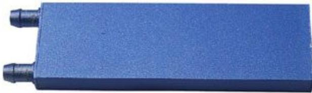
Radiatore ad acqua da utilizzare in abbinamento a 3 celle di Peltier da 51 watt. Attacchi per tubo in gomma con diametro interno da 8 mm. Dimensioni (mm): 122x41x12, peso: 86 grammi.
