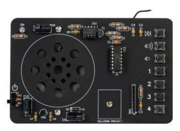
Basata su un modulo ricevitore ad elevata sensibilità, questa scatola di montaggio permette di realizzare una radio FM 88-108 MHz con possibilità di preselezionare fino a 4 stazioni radio. Alimentata con una batteria da 9 volt, dispone di un solo pulsante per la ricerca della stazione radio, interruttore ON/OFF, controllo del volume tramite pulsanti, ripristino dell'ultima stazione radio selezionata all'accensione e aumento graduale del volume.
