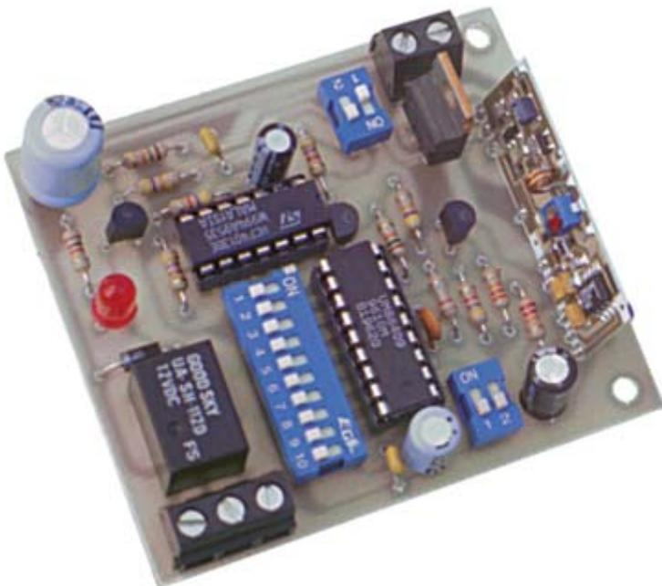
Ricevitore per radiocomando codificato monocanale in grado di garantire una grande portata. Il sistema utilizza come codificatore un integrato MM53200 (UM86409). Frequenza di lavoro di 433,92 MHz.
