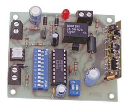
Trasmettitore per radiocomando codificato monocanale in grado di garantire una grande portata: i 400 mW del trasmettitore Aurel consentono di operare, in aria libera, anche a 2
