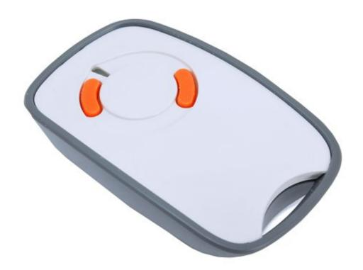
Radiocomando a due canali in grado di apprendere i codici della maggior parte dei trasmettitori codificati funzionanti a 433 MHz: il tutto senza aprire il trasmettitore, semplicemente avvicinando il trasmettitore originale al radiocomando NITRO2! Funziona sia con i trasmettitori con codifica a 12 bit (MM53200, UM86409, ecc) che con quelli che utilizzano la codifica Motorola.
