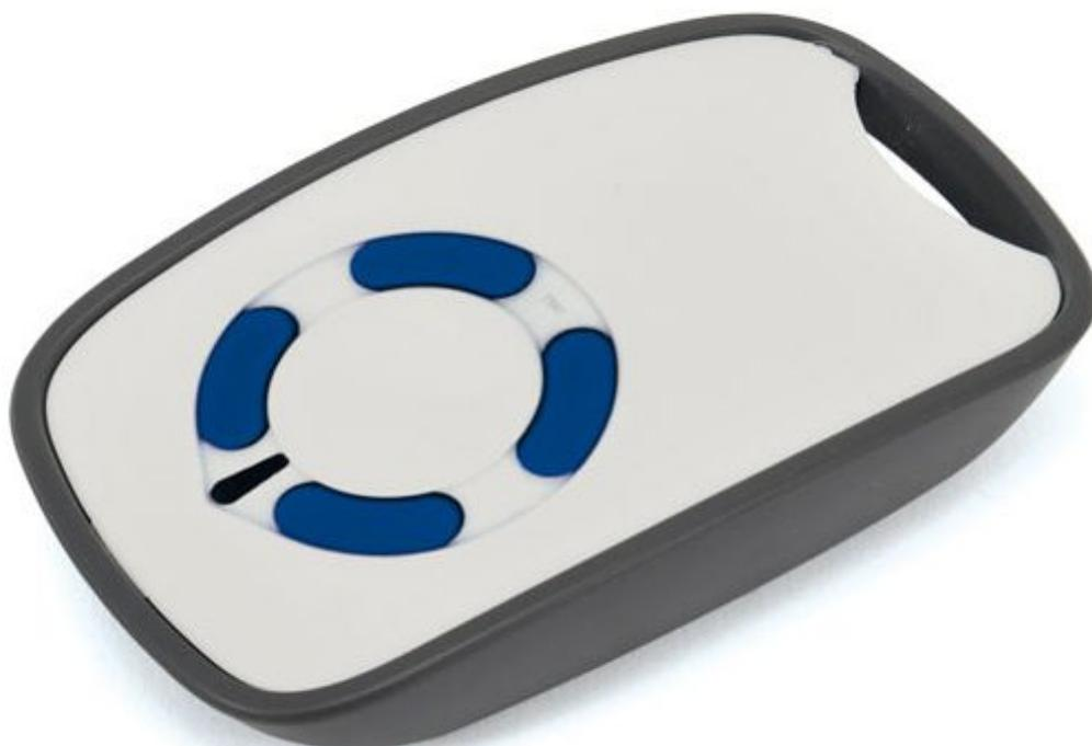
Radiocomando a 4 canali con frequenza di funzionamento a 433 MHz. Particolarmente indicato per applicazioni nel campo di antifurti e comandi codificati ove si richiedano alta efficienza e bassa emissione di spurie. In accordo con le Normative Europee EN 300 200 ed ETS 300 683 (Compatibilità Elettromagnetica). Encoder : 86409 - 7 mA @12V, 1mW E.R.P. Dimensioni (mm): 62x35x10.
