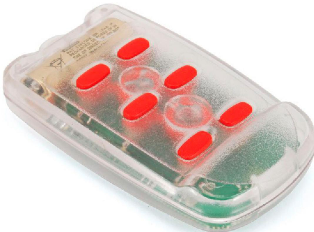
Radiocomando a 6 canali con funzione di autoapprendimento. È in grado di apprendere i codici della maggior parte dei trasmettitori codificati funzionanti a 433 MHz, semplicemente avvicinandogli il trasmettitore originale. Funziona sia con i trasmettitori con codifica a 12 bit (MM53200, UM86409, ecc) che con quelli che utilizzano la codifica Motorola.
