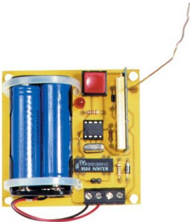
Ricevitore in UHF per comando a distanza, abbinabile a trasmettitori con codifica Motorola MC145026, dei quali può memorizzare i codici automaticamente. Sfruttando l'uscita a relè è possibile comandare accensione e spegnimento a distanza dei moderni Personal Computer, con alimentazione ATX.
