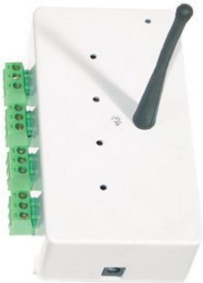
Controllo a distanza in UHF in grado di gestire quattro rel
