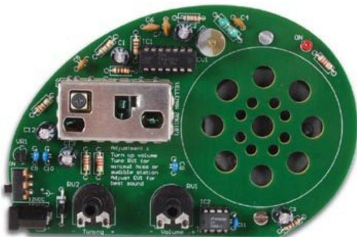
Radio FM pre-assemblata e testata. Riceve la banda FM completa : 88-108 MHz con interruttore ON/OFF, controllo del volume e spia LED.
