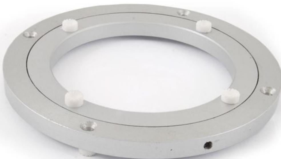
Ralla in lega di alluminio da 5,5" a un giro di sfere con 4 fori svasati passanti (per ciascuna corona) completa di 8 piedini in gomma (Ø 9 mm x H 4,6 mm). Robusta, precisa e resistente alla corrosione, è perfetta per la realizzazione di piattaforme girevoli per TV, monitor, esposizioni, sculture, centri tavola, ecc. I piedini possono essere facilmente rimossi per consentire il fissaggio a strutture o supporti mediante viti.
