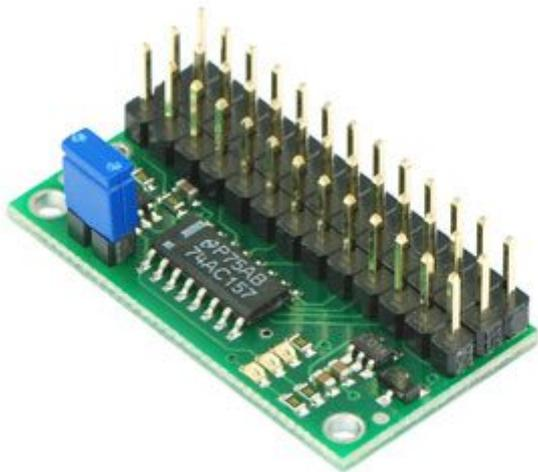
Multiplexer a quattro canali che permette una facile commutazione di un servo RC fra due fonti indipendenti. Dispone di 4 pin (da S1 a S4) per i segnali di ingresso slave, 4 pin (da M1 a M4) per i segnali di ingresso master e 4 pin (da OUT1 a OUT4) per le uscite multiplex. La loro sorgente è determinata dal segnale sul pin di SEL. Ad esempio, è possibile collegare due ricevitori RC allo stesso gruppo di servi (o dispositivi simili) o un ricevitore RC e un controller per servo.
