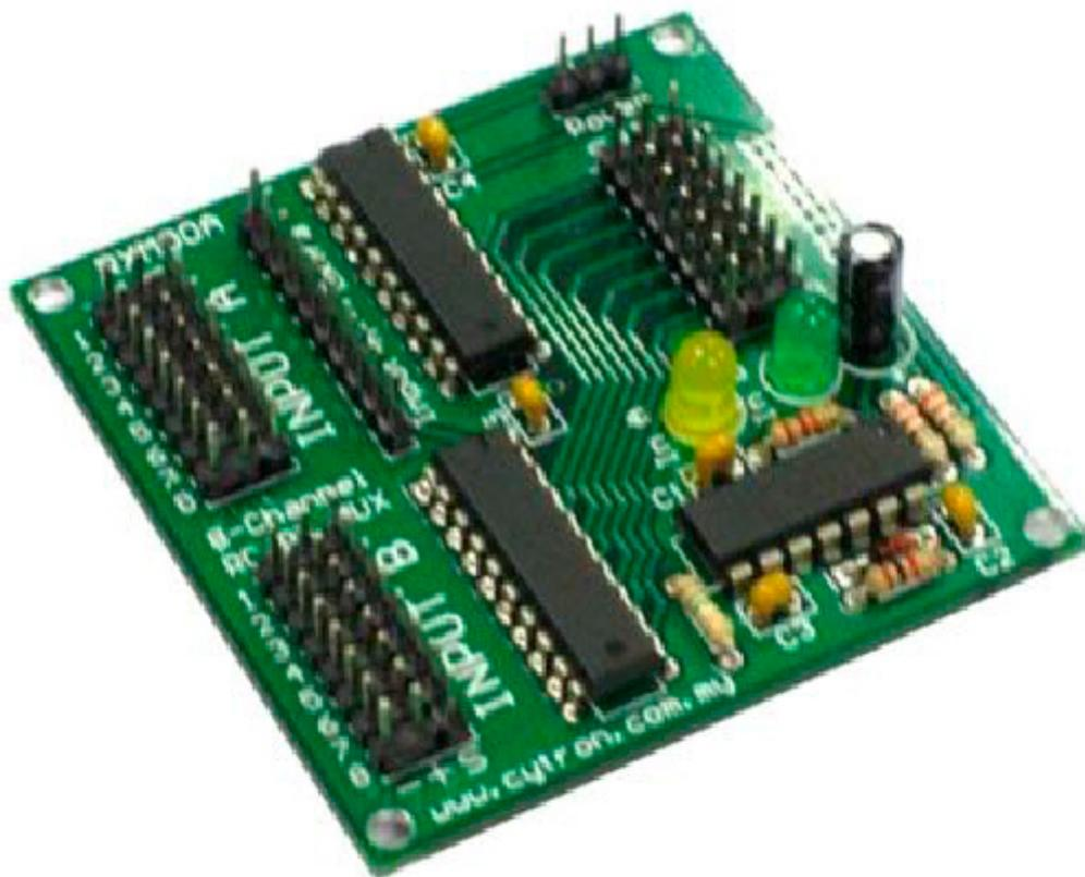
Multiplexer a otto canali che permette una facile commutazione di un servo RC fra due fonti indipendenti utilizzando l'ottavo canale dell'ingresso A come selettore di uscita. Le sorgenti del segnale possono provenire da ricevitori R/C, autopilot o microcontrollore collegati all'ingresso B. Ideale per applicazioni in cui l'utente ha due possibili sorgenti di controllo e vuole passare rapidamente da una all'altra. Alimentazione: 6 Vdc, dimensioni (mm): 61x61x13.
