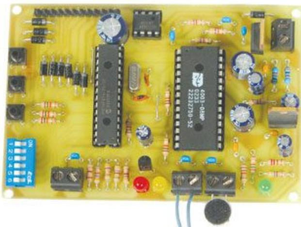
Consente di registrare e riprodurre su supporto digitale 64 messaggi audio. Utilizza il nuovo integrato ISD 4003-8 in grado registrare per un tempo massimo di 8 minuti complessivi. Il dispositivo - fornito in scatola di montaggio - comprende tutti i componenti, il microfono, l'altoparlante ed il micro programmato. Non
