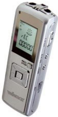
Registratore/riproduttore digitale audio con lettore MP3 integrato e con memoria flash da 512 MB. Consente di registrare fino a 144 ore, si interfaccia ad un PC tramite porta USB e viene rilevato come unità removibile esterna. Alimentazione mediante batteria ministilo (inclusa). Vasta gamma di accessori tra cui microfono esterno, auricolare stereo, connettore per linea telefonica, ecc. Sistema VOR per attivazione automatica della registrazione in presenza di segnali sonori.
