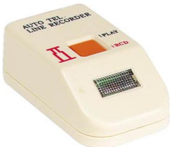
Compatto ed economico apparecchio che, collegato all'impianto telefonico e ad un registratore audio a cassetta con presa rem, consente di registrare le telefonate. Il TELREC, a seconda dell'operazione che si sta compiendo (inizio o fine conversazione), invia all'ingresso rem del registratore un segnale differente, permettendo di avviare o arrestare la registrazione. Facilissimo da installare.
