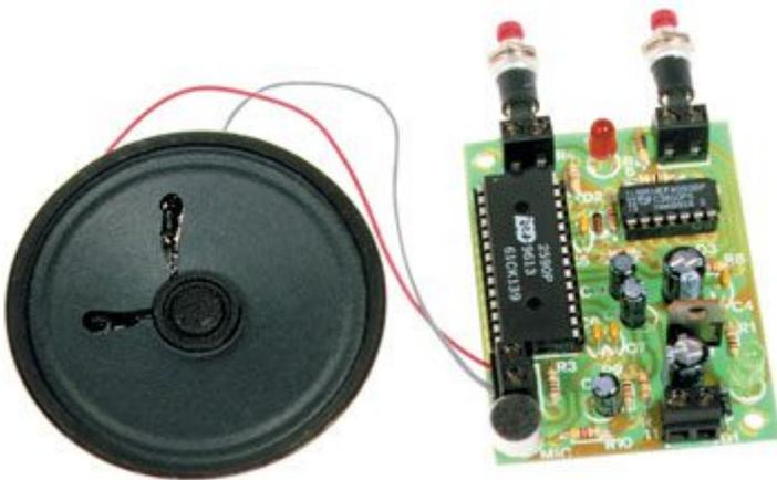
Registatore/riproduttore in grado di memorizzare e riprodurre messaggi della durata di 60 o 90 secondi. Completo di microfono e di altoparlante. Utilizza gli integrati della serie ISD2000 da 60 o 90 secondi (specificare nell
