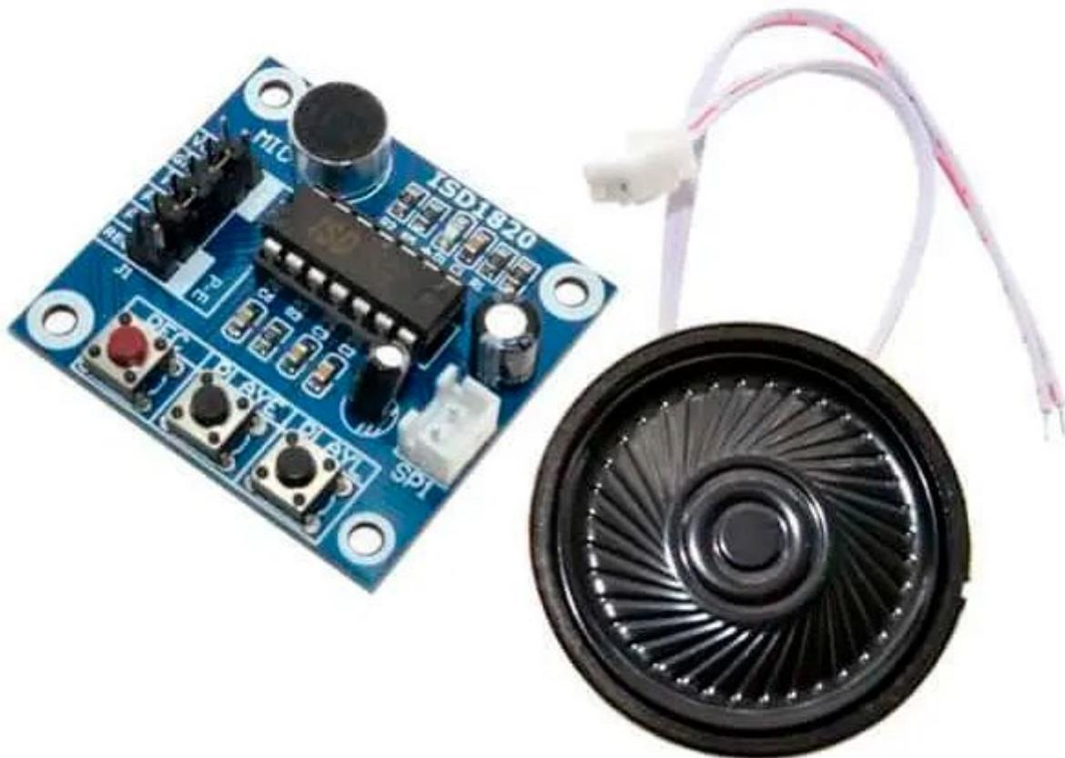
Registratore/riproduttore vocale a singolo messaggio in grado di registrare fino ad massimo di circa 10 secondi. Dispone di microfono electret, pulsanti di controllo (REC, PLAYE e PLAYL), altoparlante da 8 ohm 0,5 watt diametro 40 mm, connettore strip 2x6 pin con alimentazione e ingressi per controllo esterno tramite Arduino, Fishino o altro microcontrollore. Può essere utilizzato per messaggi di benvenuto, riprodurre messaggi, ecc.
