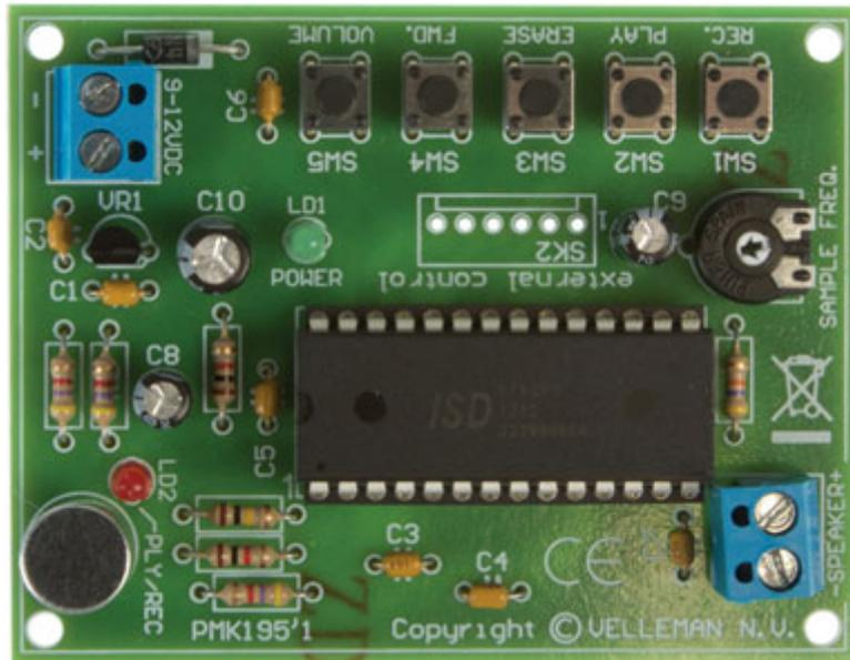
Registratore/riproduttore vocale a singolo messaggio. Tempo di registrazione compreso tra 30 e 90 secondi, ingressi esterni open collector (registrazione, riproduzione, cancellazione, messaggio successivo e volume), trimmer per la regolazione della velocità di riproduzione. Microfono e altoparlante da 57 mm. Può essere usato per messaggi di benvenuto, riprodurre messaggi, ecc.
