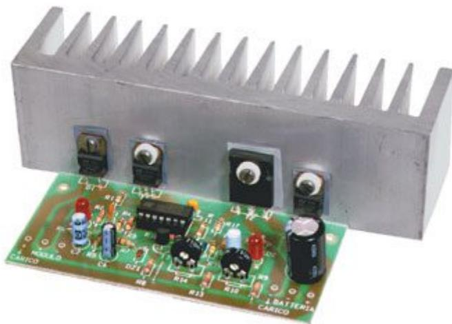
Collegato fra il pannello e le batterie consente di limitare l'afflusso di corrente in queste ultime quando si sono caricate a sufficienza: interrompe invece il collegamento con l'utilizzatore quando la batteria è quasi scarica. Il circuito è in grado di lavorare con correnti massime di 15 A. Sezione di potenza completamente a mosfet. Dotato di tre LED di diagnostica.
