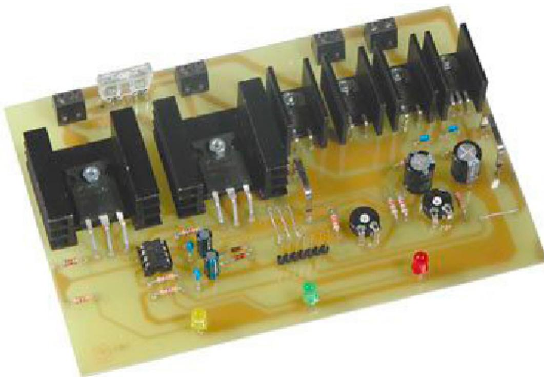
Regolatore di carica per pannelli solari gestito da microcontrollore. Adatto sia per impianti a 12 che a 24 volt. Massima corrente di uscita 10-15 A. Completamente allo stato solido.
