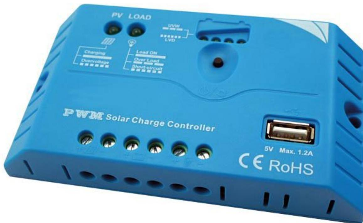
Efficiente regolatore di carica PWM per applicazioni fotovoltaiche in grado di funzionare automaticamente sia a 12 che a 24 V. Dispone di porta USB 5 VDC per caricare apparecchiature elettroniche, indicatore LED per lo stato della batteria, protezioni da sovraccarico, cortocircuito, sovra-scarica, sovratensione, bassa tensione, inversione di polarità.
