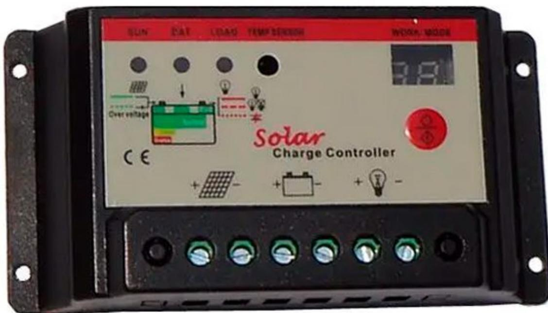
Regolatore di carica per applicazioni fotovoltaiche controllato da microcontrollore e in grado di funzionare automaticamente sia a 12 che a 24 V. Consente di fornire il giusto grado di corrente alle batterie proteggendole da un eccesso di scarica o carica con lo scopo di prolungarne il più possibile il ciclo di vita. **Attenzione!** utilizzare solo con pannelli solari da 12 e 24 V.
