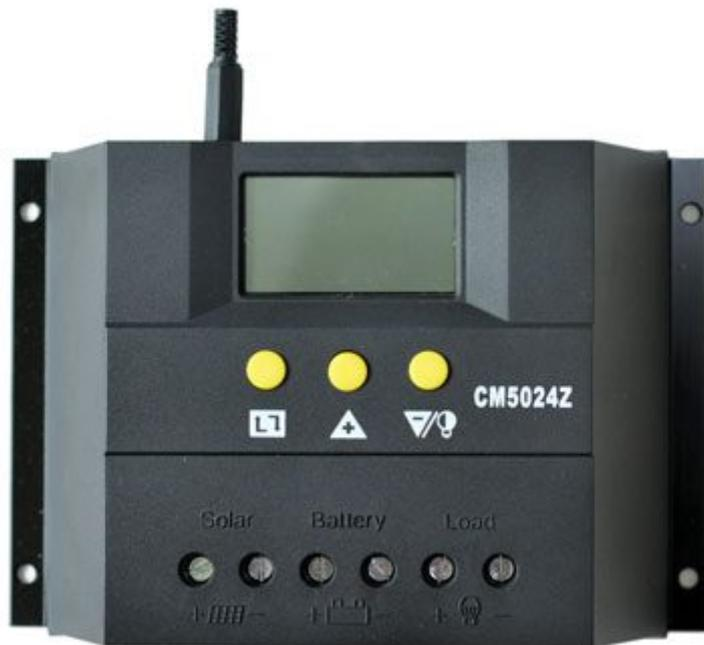
Regolatore di carica per applicazioni fotovoltaiche controllato da microcontrollore, dotato di display LCD e in grado di funzionare automaticamente sia a 12 che a 24 V. Consente di fornire il giusto grado di corrente alle batterie proteggendole da un eccesso di scarica o carica con lo scopo di prolungarne il più possibile il ciclo di vita. Attenzione! utilizzare solo con pannelli solari da 12 e 24 V.
