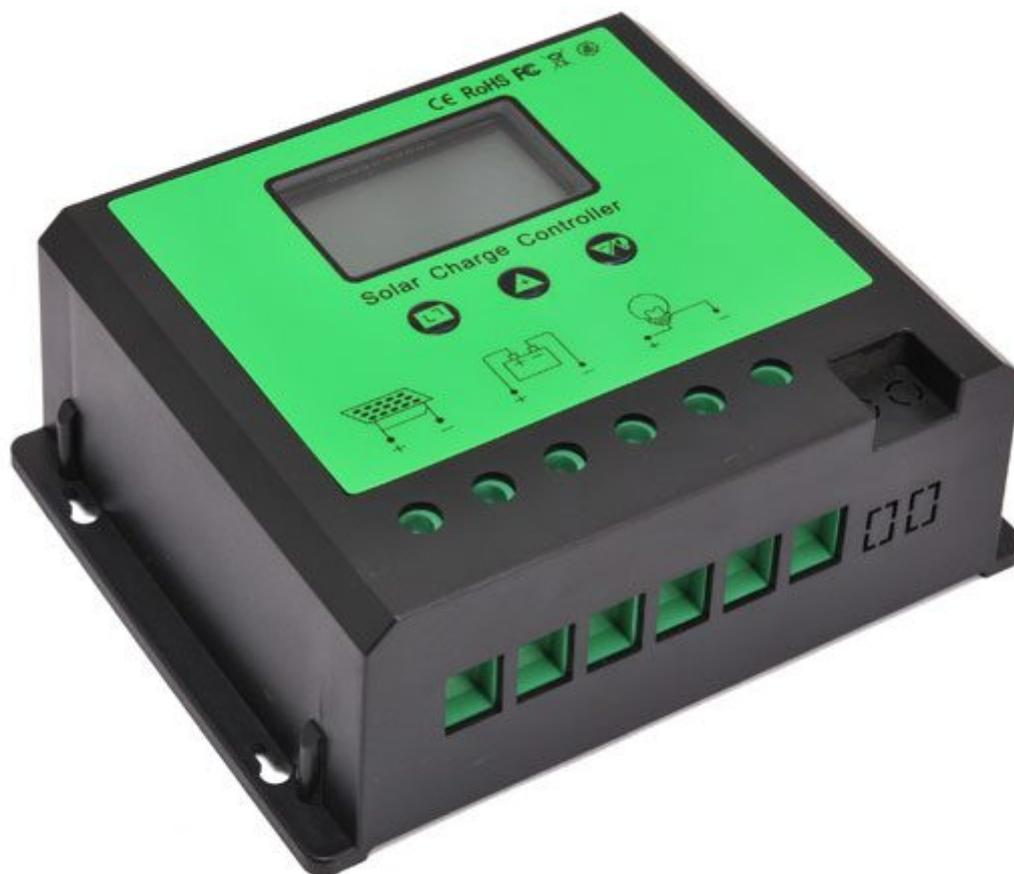
Regolatore di carica per applicazioni fotovoltaiche controllato da microcontrollore, dotato di display LCD e in grado di funzionare automaticamente sia a 12 che a 24 V. Consente di fornire il giusto grado di corrente alle batterie proteggendole da un eccesso di scarica o carica con lo scopo di prolungarne il più possibile il ciclo di vita. Attenzione! utilizzare solo con pannelli solari da 12 e 24 V.
