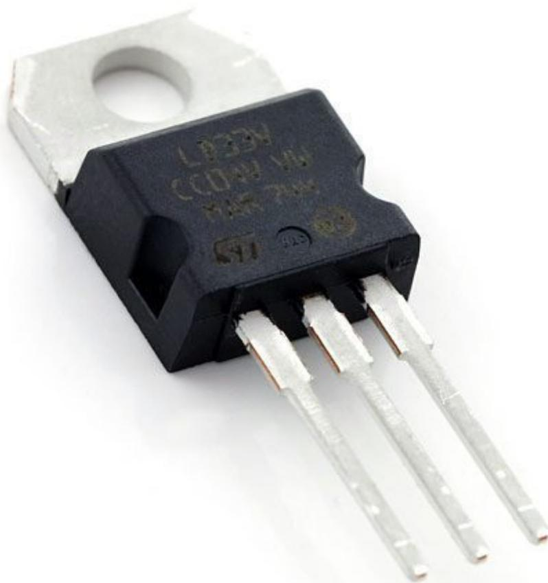
Regolatore di tensione LD1117V33 a basso dropout, con uscita fissa a 3,3 V e in grado di erogare una massimo di 800 mA. Case TO220.
