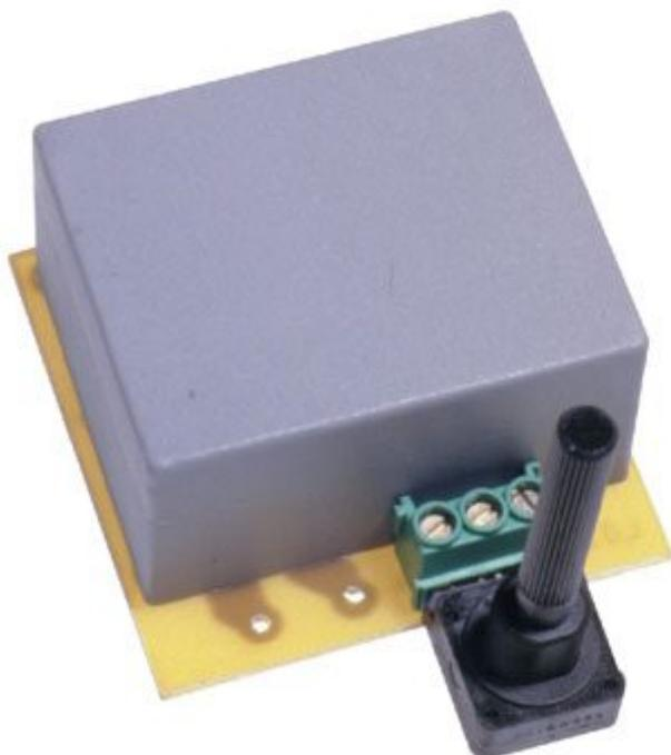
Progettato esplicitamente per regolare tensione e corrente d'uscita dei pannelli solari, può essere adoperato ovunque sia richiesto di stabilizzare la differenza di potenziale fornita da un alimentatore in continua e limitarne la corrente erogata al carico o ad una batteria. Tensione di lavoro 12÷24 V, corrente massima 500 mA. Il kit comprende tutti i componenti, la basetta forata e serigrafata e lo scatola plastica.
