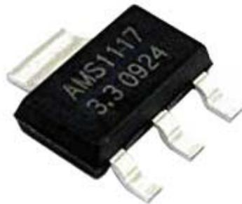
Regolatore di tensione AMS1117 a basso dropout, con uscita fissa a 3,3 V e in grado di erogare una massimo di 1100 mA. Case SOT-223.
