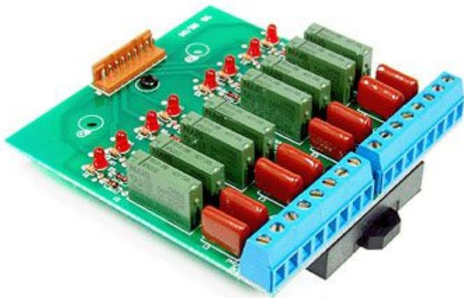
Scheda dotata di 8 relè che permette di controllare, tramite i moduli CUBLOC e CUTOUCH, l'attivazione/disattivazione di dispositivi funzionanti con tensioni massime di 110 Vdc o 250 Vac. La scheda dispone di funzione Plug-N-Play quando viene connessa alle schede CuBASE o CuTOUCH. Ogni uscita è dotata di soppressore di disturbi.
