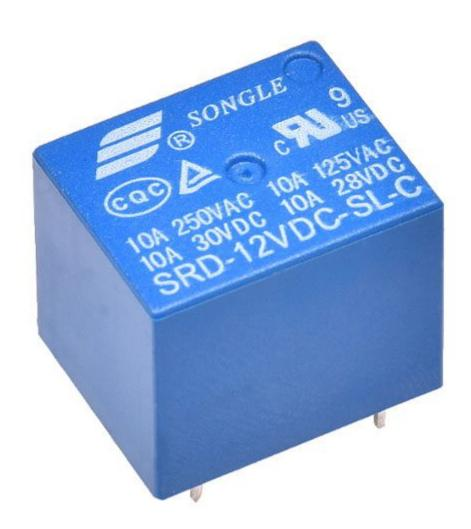
Relè di potenza a singolo scambio da circuito stampato. Tensione bobina 12Vdc, resistenza bobina 360 ohm, potenza nominale assorbita 450 mW, portata contatti 10A / 28Vdc-125 Vac, 7A / 220Vac, rigidità dielettrica 1000V / 50Hz (1 minuto), materiale contatti interni AgCd0.
