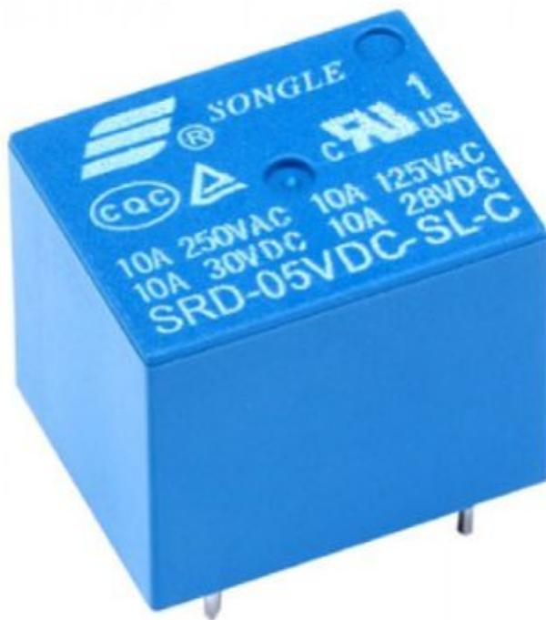
Relè miniatura a singolo scambio da circuito stampato. Tensione bobina 5 VDC, resistenza bobina 89,3 ohm, potenza nominale assorbita 450 mW, portata contatti 10 A / 28 VDC – 125 VAC, 10 A / 220 VAC, rigidità dielettrica 1000 VAC / 50 Hz (1 minuto), materiale contatti interni AgCdO. Dimensioni (mm): 19x15,2x15,3.
