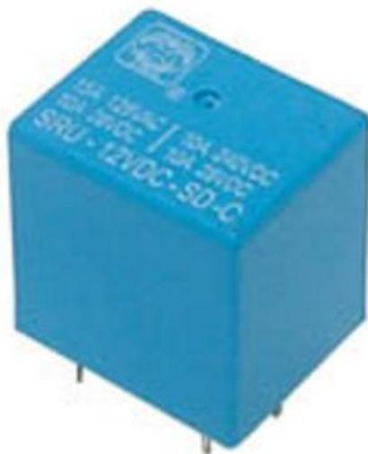
Relè miniatura a singolo scambio da circuito stampato. Tensione bobina 6 VDC, resistenza bobina 90 ohm, potenza nominale assorbita 450 mW, portata contatti 15 A / 28 VDC – 125 VAC, 7A / 220 VAC, rigidità dielettrica 1000V / 50Hz (1 minuto), materiale contatti interni AgCd0. Dimensioni (mm): 20,3x20,2x16,3.
