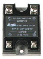
Relè allo stato solido a singolo contatto, isolato otticamente, dotato di protezione <u>snubber</u>, TTL e CMOS compatibile. Tensione bobina: da 3 a 32 Vdc, impedenza d'ingresso: 2 kohm, portata contatto: 240 Vac/ 25 A.
