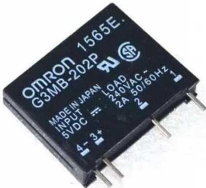
Relè allo stato solido da circuito stampato, case single-in-line, isolato otticamente.
