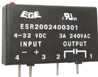
Relè allo stato solido da circuito stampato, case single-in-line, isolato otticamente, LED indicatore tensione d'ingresso, TTL e CMOS compatibile.
