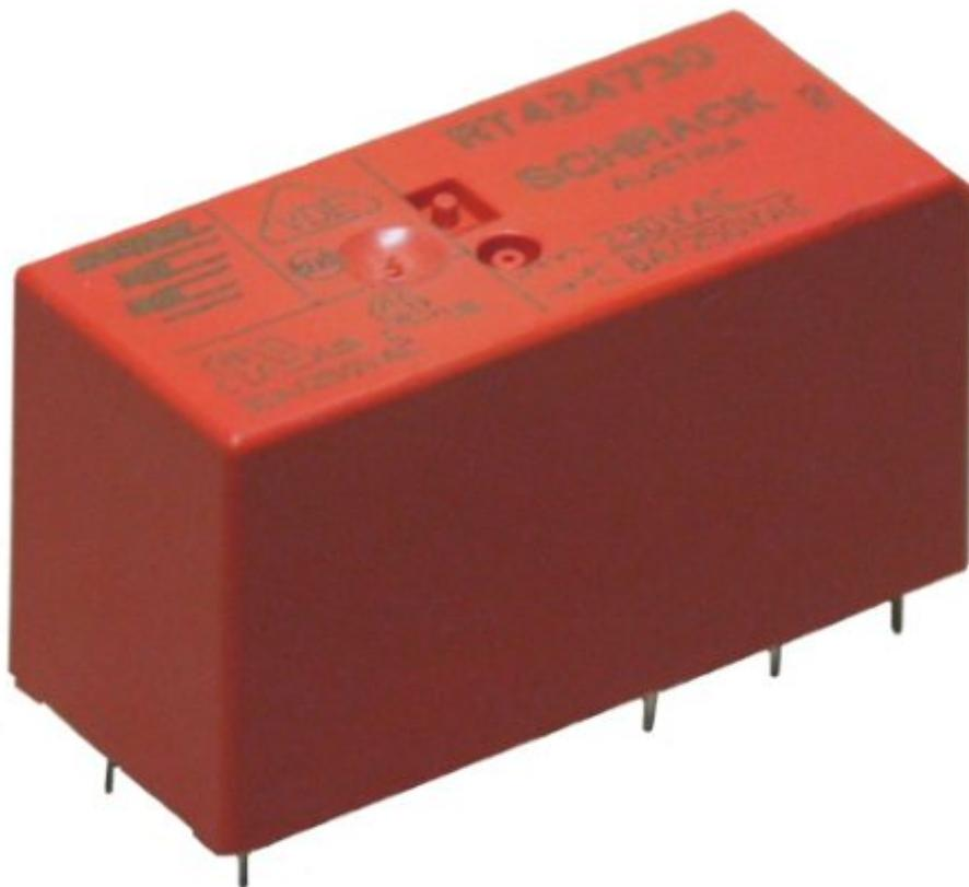
Relè di potenza, doppio scambio DPDT da circuito stampato. Bobina di attivazione a 230 VAC, portata contatti: 8A max / 250 VAC, tempo di eccitazione 7 ms, isolamento 5KV. Peso: 13,50 grammi.
