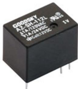
Relè sigillato con terminali da circuito stampato. È caratterizzato da dimensioni estremamente compatte (15,6 x 10,8 x 12,4 mm), da una elevata sensibilità ed affidabilità. Alimentazione bobina: 12 Vdc / 13 mA, portata contatti: 1A/120 Vac.
