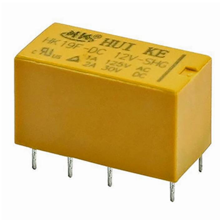
Relè miniatura da circuito stampato con bobina 12 VDC, doppio scambio, portata 2A / 30VDC, piedinatura DIL, dimensioni mm 20.2x10, altezza mm 12.
