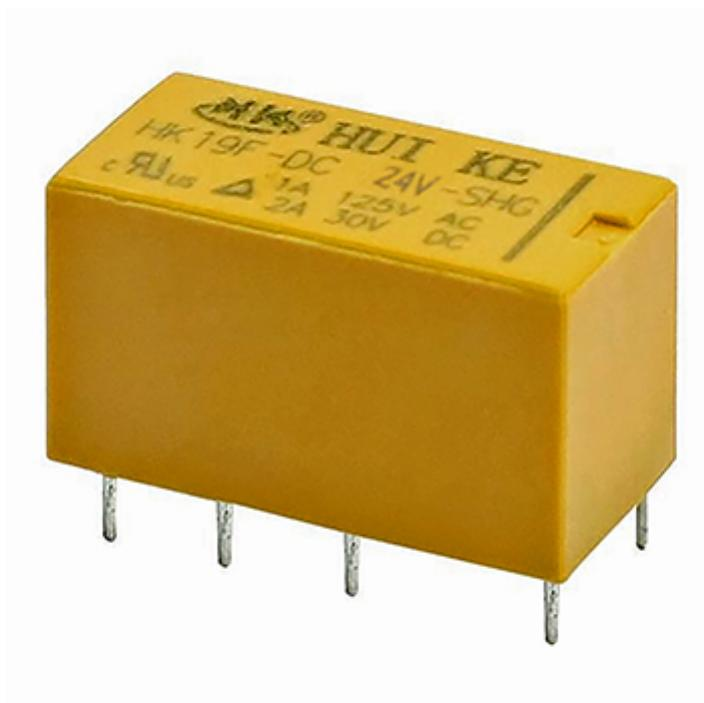
Relè miniatura da circuito stampato con bobina 24 VDC, doppio scambio, portata 2A / 30VDC, piedinatura DIL, dimensioni mm 20.2x10, altezza mm 12.
