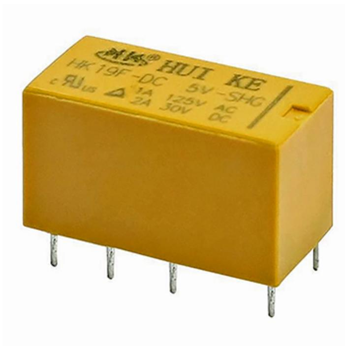
Relè miniatura da circuito stampato con bobina 5 VDC, doppio scambio, portata portata 2A / 30VDC, piedinatura DIL, dimensioni mm 20.2x10, altezza mm 12.
