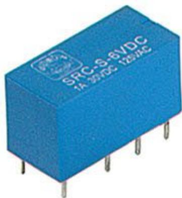
Relè DIL sigillato con terminali da cs. Dimensioni 20,6x10,6x12,2 mm, elevata sensibilità ed affidabilità. Contatti interni in AgCd0 placcati oro, portata contatti 1A/30Vdc, potenza assorbita 450 mW.
