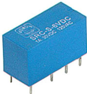
Relè DIL doppio scambio 24 Vdc - resistenza bobina 1280 ohm, contatti interni dorati, temperatura di funzionamento da -25°C a +55°C, potenza 450 mW.
