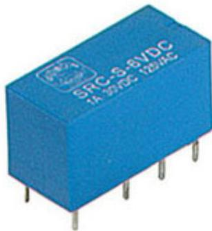
Relè DIL doppio scambio 6 Vdc - resistenza bobina 80 ohm, contatti interni dorati, temperatura di funzionamento da -25°C a +55°C, potenza 450 mW.
