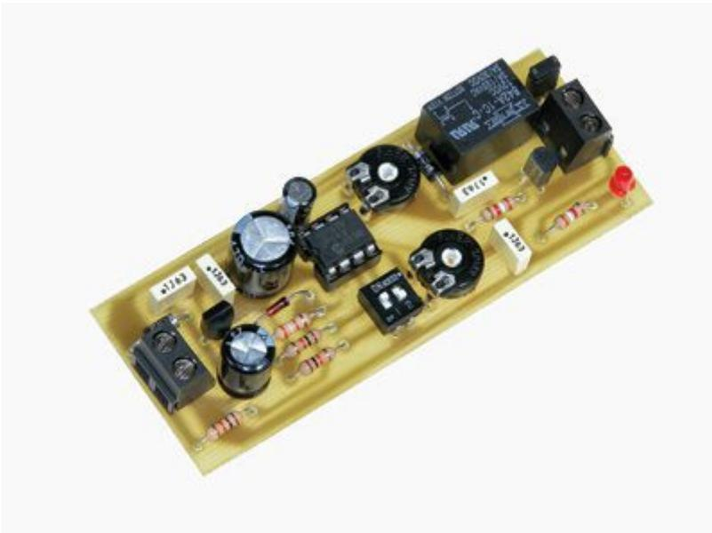
Dispositivo da collegare tra una sorgente di alimentazione a batteria e circuiti basati su moduli GPS/GSM. Provvede a scollegare il carico dalla batteria ad intervalli prestabiliti e quando la tensione della batteria scende al di sotto di un valore selezionato.
