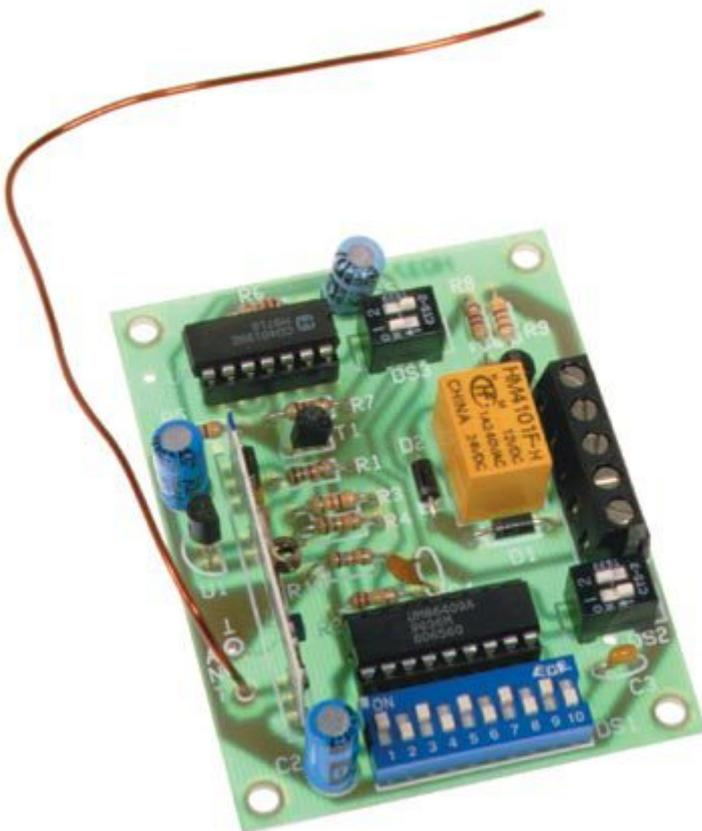
Ricevitore per radiocomando realizzato con il modulo Aurel BC-NBK omologato in Italia (PT) ed in Germania (BZT) in accordo con le normative CE. Versione monocanale. Funzionamento dei rel
