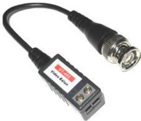
Consente di inviare (tramite cavo UTP 5) un segnale video a colori fino a 400 metri e un segnale video in bianco/nero fino a 600 metri senza essere alimentato. Particolarmente indicato per essere impiegato con sistemi di registrazione digitale. Questo modulo può funzionare sia da trasmettitore che da ricevitore. Non necessita di alimentazione e non trasmette l'audio. La confezione comprende 1 pezzo. Per il funzionamento occorre utilizzare due ricetrasmettitori.
