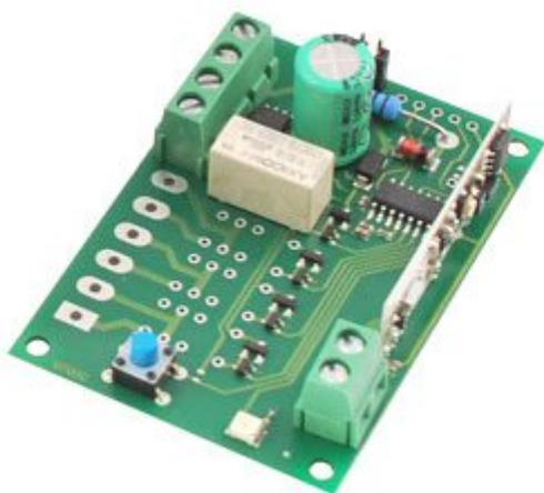
Ricevitore monocanale ad auto apprendimento operante a 433,92 MHz con decodifica HCS. Può essere comandato con un qualsiasi trasmettitore con codifica HCS300 o HCS301. Il relè di uscita può operare sia in modalità monostabile che in modalità bistabile. Il ricevitore può essere alimentato con tensione continua o alternata, dispone di un selettore della tensione di alimentazione (12 Vdc oppure 24 Vac).
