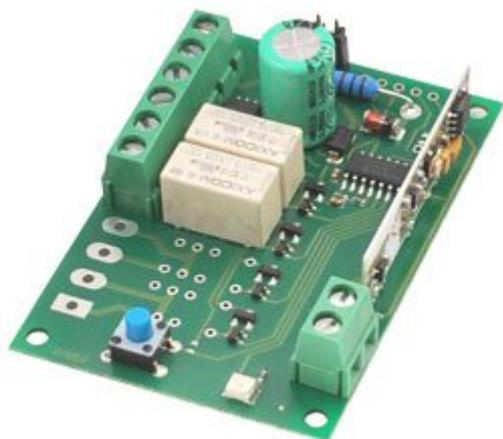
Ricevitore a due canali ad auto apprendimento operante a 433,92 MHz con decodifica HCS. Può essere comandato con un qualsiasi trasmettitore con codifica HCS300 o HCS301. Il relè di uscita può operare sia in modalità monostabile che in modalità bistabile. Il ricevitore può essere alimentato con tensione continua o alternata, dispone di un selettore della tensione di alimentazione (12 Vdc oppure 24 Vac).
