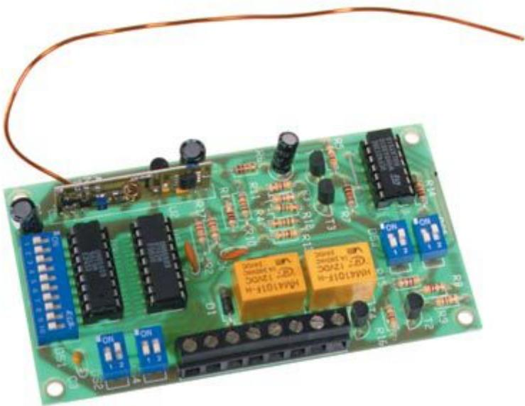
Ricevitore per radiocomando realizzato con il modulo Aurel BC-NBK omologato in Italia (PT) ed in Germania (BZT) in accordo con le normative CE. Versione bicanale. Funzionamento dei rel
