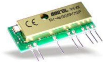
Ricevitore RF economico con micro assorbimento. Elevata selettività ed alta immunità ai campi elettromagnetici interferenti, ottenuta con l'impiego di filtro SAW in ingresso e schermo metallico. Utilizzabile con trasmettitori AM OOK 433.92 (escluso TX-SAW 434 DF) e Tx Palmari (esclusi quelli con HCSxxx). Alimentazione: 3 V, Consumo: 70  $\mu$ A, Frequenza: 433.92 MHz, Sensibilità: -94 dBm, Bit rate: 2400 bps, Dimensioni: 40.1x17.5x5.5 mm (Codice Aurel: RX-4M30RR01SF, 650200590).
